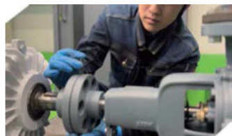
遠心式 渦巻ポンプ 芯出し調整
